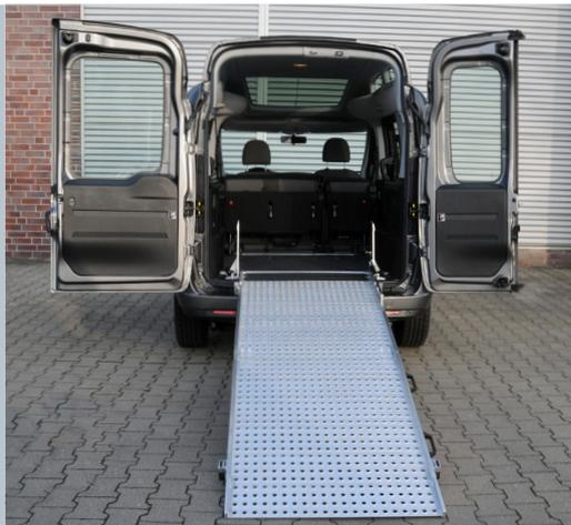
Fahrzeug mit ausgeklappter Rampe. (Maße: Länge 2.400 x Breite 800 mm)
