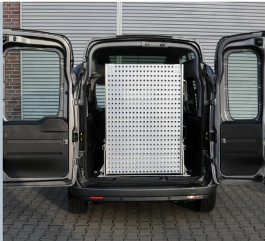
Eingeklappte Eurorampe in Ruhestellung im Fahrzeugheck.
